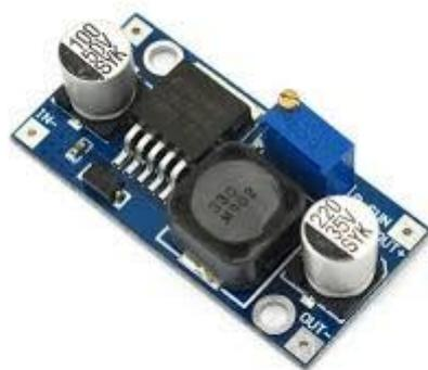
Рисунок 2.8 – Преобразователь DC DC
