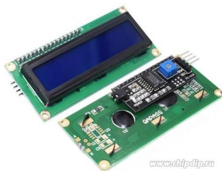
Рисунок 2.4 – LCD1602I2C дисплей
